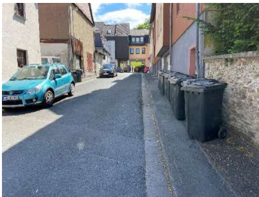
Abbildung 43: Hindernis im Lichtraumprofil (Am Füllgarten)
